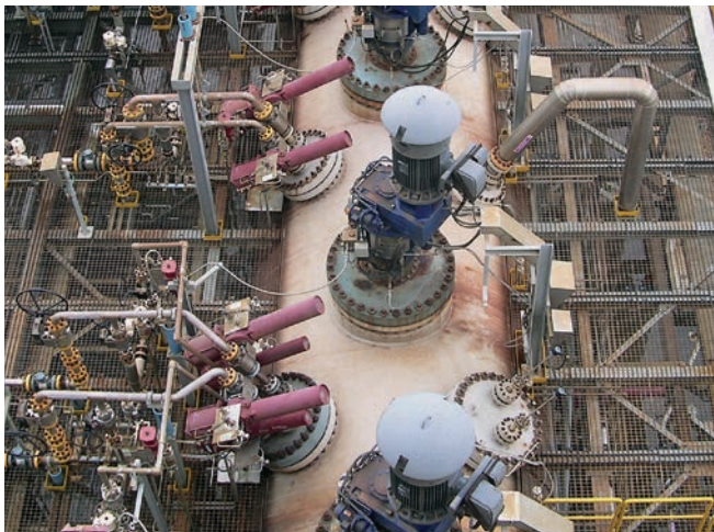
Крупный азиатский горнообработывающий комплекс сохраняет эксплуатационную надежность своих автоклавов с помощью шаровых клапанов MOGAS для суровых условий. Патентованное покрытие MOGAS является крайне важным компонентом, обеспечивающим надежность функционирования клапана.
