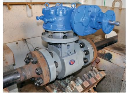
此款 4 英寸 ASME 1500 级球阀被置于火中，进行预定时间的防火测试。
