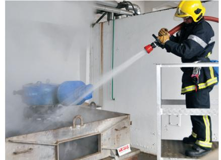
防火测试的最后一步是验证阀门的操作能力并记录阀门的性能。MOGAS 阀门不仅顺利通过防火测试，而且性能远超客户的关键要求。
