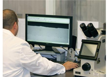
使用 Vickers 压痕显微硬度测试验证硬度和开裂敏感性。
