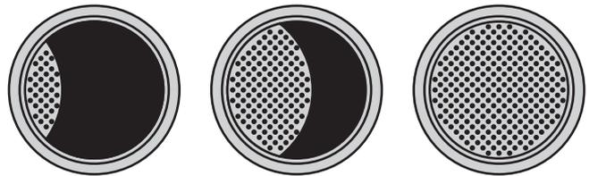
可变阀内件技术能够调节镗孔填充比例，以符合特定应用要求。图示范例的填充比例为 10% 至 100%。
