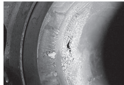
Tal y como se muestra en esta válvula de la competencia, si los asientos no están protegidos de la exposición constante al vapor de alta presión, puede ocurrir una erosión destructiva.
