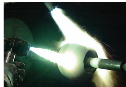
Con la tecnología más reciente, esta bola iRSVP recibe un recubrimiento de HVOF. Los recubrimientos de MOGAS están especialmente seleccionados para manejar las condiciones de funcionamiento de cada aplicación.
