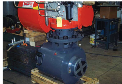
Esta válvula de aislamiento de recirculación de la bomba de alimentación de la caldera se fabricó con extremos de cubo de alta presión con abrazaderas para permitir que el cliente retire fácilmente la válvula para repararla. Esto elimina el tener que cortar dos soldaduras muy delgadas, volviendo a soldar y posteriormente tratar térmicamente la soldadura de soldadura.
