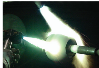
Cette sphère iRSVP reçoit un revêtement par projection d'oxy-gaz à grande vitesse (HVOF) en utilisant la dernière technologie en date. Les revêtements MOGAS sont notamment choisis pour répondre aux besoins liés aux conditions d'utilisation de chaque application.
