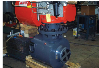
Esta válvula de isolamento da recirculação da bomba de alimentação da caldeira foi fabricada com terminais de hub de alta pressão, com fixadores para possibilitar ao cliente a fácil remoção da válvula para reparo. Isto elimina ter de quebrar duas soldas muito duras, refazer a solda e o tratamento térmico pós-solda.
