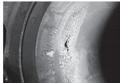
Como mostrado na válvula deste concorrente, se os assentos não são protegidos contra a exposição constante ao vapor de alta pressão, pode ocorrer uma erosão destrutiva.
