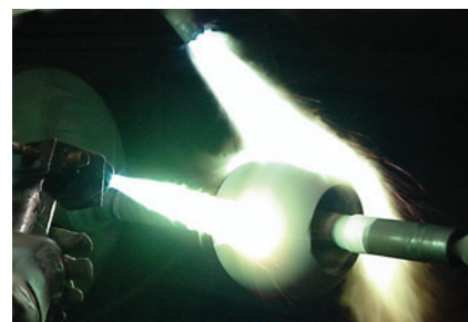
Usando a mais recente tecnologia, esta iRSVP esférica recebe um revestimento por HVOF. Os revestimentos da MOGAS são especialmente escolhidos para lidar com as condições de funcionamento de cada aplicação.
