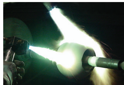
这款 iRSVP 阀球正在运用最新技术进行 HVOF 涂层。MOGAS 涂层专为每种应用的操作环境特别选定。
