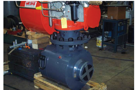
这款锅炉给水泵再循环隔离阀采用卡箍联接方式，使客户可以在维修时轻松地卸下阀门。避免切割两端厚实的焊接层，并免除了之后重新焊接以及焊接后加热处理的工序。
