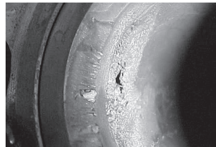
如这个竞争对手的阀门所示，如果阀座频繁地暴露在高压蒸汽下，就会受到破坏性的侵蚀。
