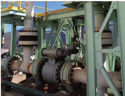
Mais de 120 válvulas da Série C, de 2 a 24 polegadas, Classe ASME 150-1500, foram instaladas nesta estação de estrangulamento de linha de concentrado para processar a polpa de cobre.
