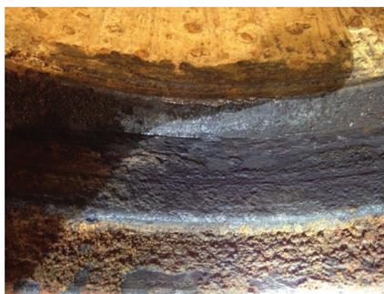
*A perda de material na ranhura da sede foi causada pela corrosão galvânica, permitindo o vazamento ao redor das sedes da válvula.*
