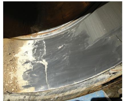
Sob as mesmas condições de processo, a válvula concorrente teve um desempenho inferior e exigiu manutenção frequente devido à erosão.
