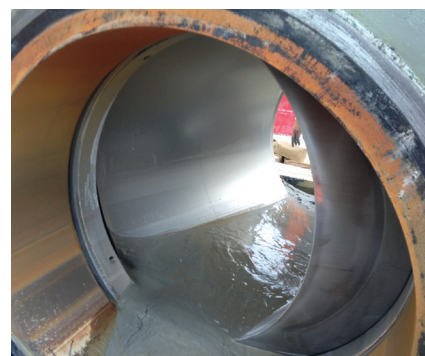
Después de un año, la válvula MOGAS realizó 818 ciclos exitosos, más de cuatro veces la cantidad de ciclos requeridos en esta aplicación.
