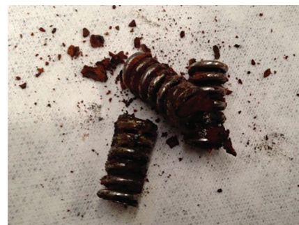
El sedimento fino recubrió el interior del resorte helicoidal, lo que impidió el movimiento libre y un sellado efectivo.
